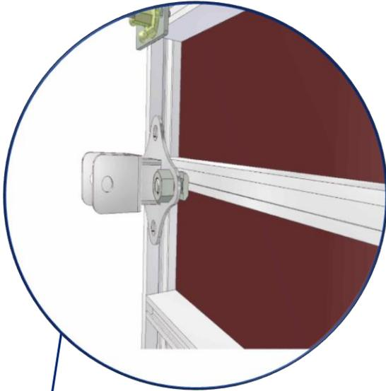
Glisser les vis en T dans la rainure du panneau, les tourner d' ¼ de tour vers la droite puis visser les écrous à l'aide de la clé de 30 pour bloquer les prises d'étais.
