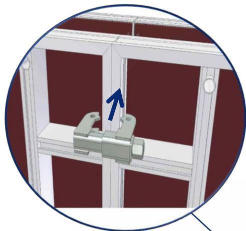
Lorsque les panneaux sont bien en place et alignés, installer les pinces d'assemblage (possibilité d'ajout d'une compensation maxi 2cm).
