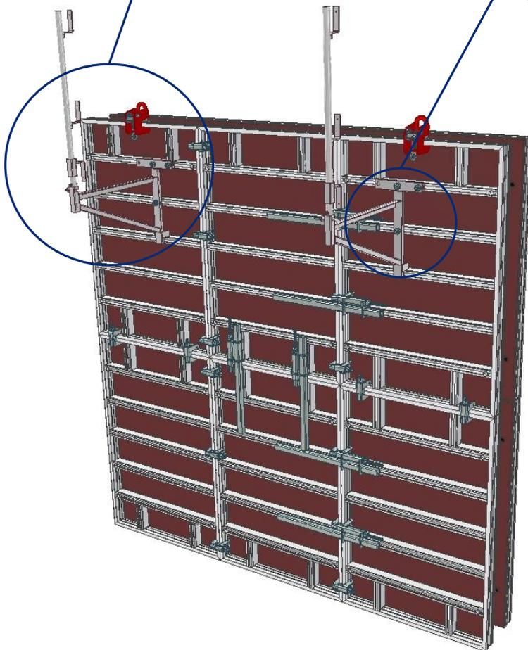
Glisser les vis en T dans la rainure du panneau, les tourner d'  $\frac{1}{4}$  de tour vers la droite puis visser les écrous à l'aide de la clé de 30 pour bloquer les consoles de service.
