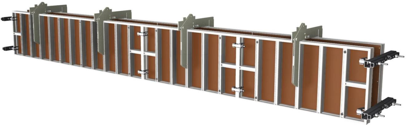
Positionner les espaceurs de longrine au milieu des panneaux par intervalle 1.5m de long, et répartir équitablement 2 espaceurs sur les panneaux de 3m de long. Adaptable sur panneau de 0,5 à 1m
