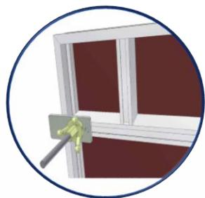
Visser les deux écrous ailés. Bien contrôler que les trous sans tiges comportent des bouchons côté face coffrante.
